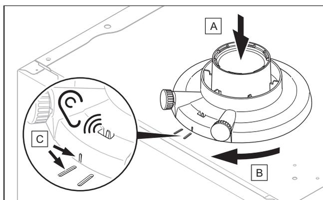
1. Mettez la pièce de raccordement standard en place. Faites bien attention aux ergots.
