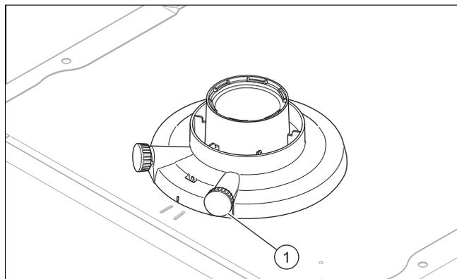
1. Ouvrez l'orifice de mesure (1) du point de mesure des gaz de combustion et montez la sonde de l'analyseur de gaz de combustion.
