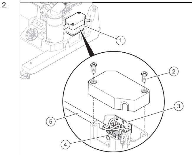
Dévissez les deux vis (2) de l'interrupteur principal de l'appareil (1).
