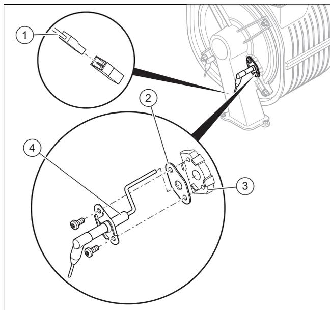
1. Débranchez le connecteur (1) du câble de l'électrode de régulation.
