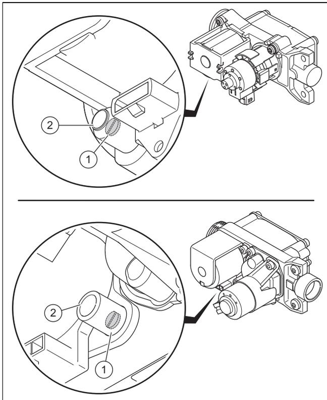
3. Desserrez la vis de contrôle (1).
