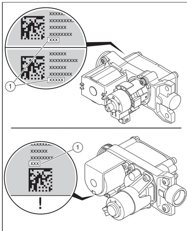
1. Relevez le décalage (1) qui figure sur la face arrière ou le dessous du mécanisme gaz. Servez-vous d'un miroir, par exemple.
