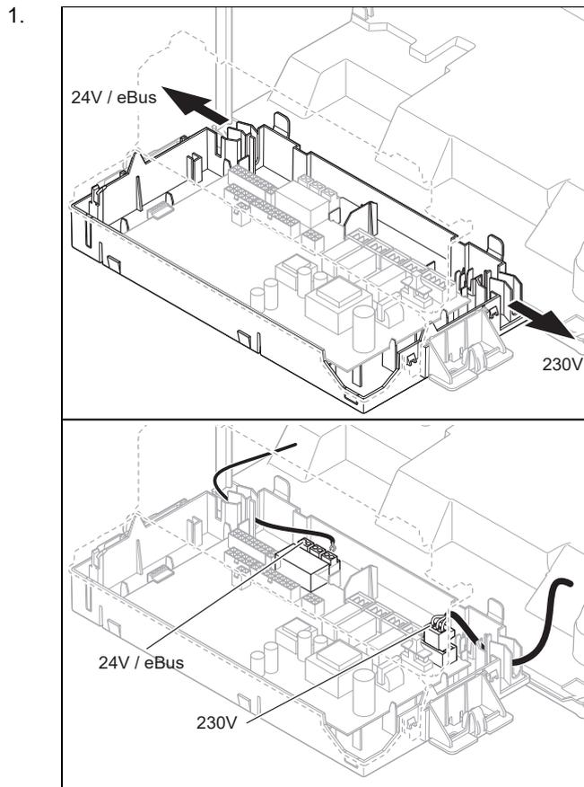
Faites passer les câbles de raccordement des composants à connecter dans le passe-câbles situé en bas du produit, à gauche.
