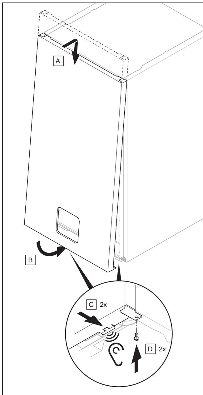
1. Serrez les deux vis situées en bas du produit, à gauche et à droite.
