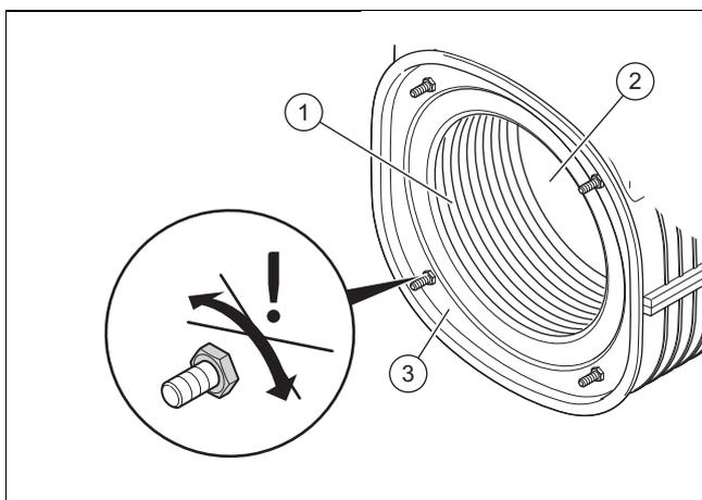
1. Nettoyez le serpentin (1) de l'échangeur thermique (3) avec de l'eau et du vinaigre si nécessaire (5 % d'acidité maximum).
