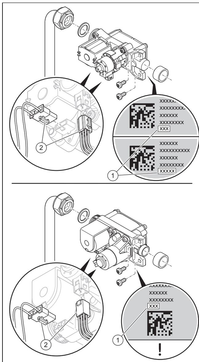
1. Débranchez les deux connecteurs (2) du mécanisme gaz.
