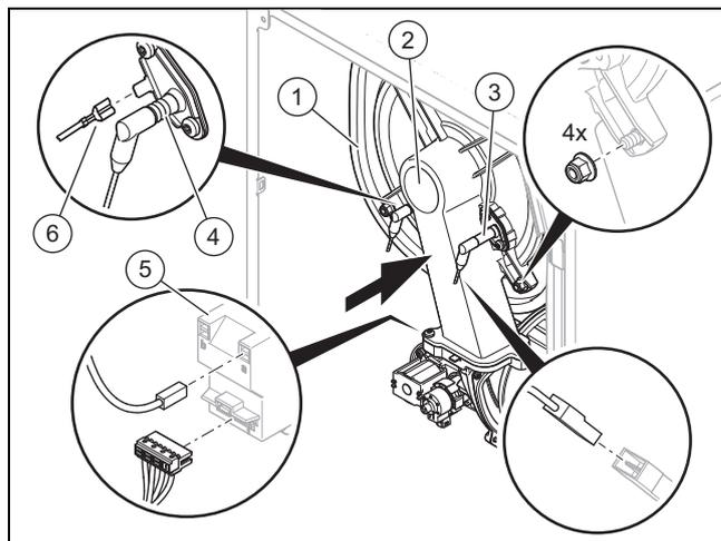
1. Placez le module compact thermique sur l'échangeur thermique (1).
