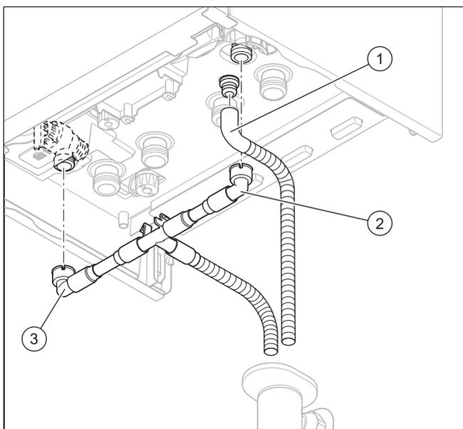
1. Placez les tuyaux d'évacuation fournis pour effectuer les raccordements de sorte qu'ils ne gênent pas le retrait et la mise en place de la partie inférieure du siphon.
