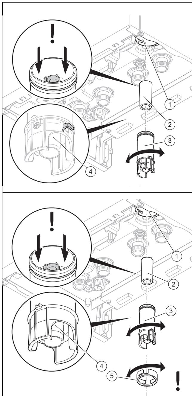
1. Desserrez le circlips (5) si nécessaire.
