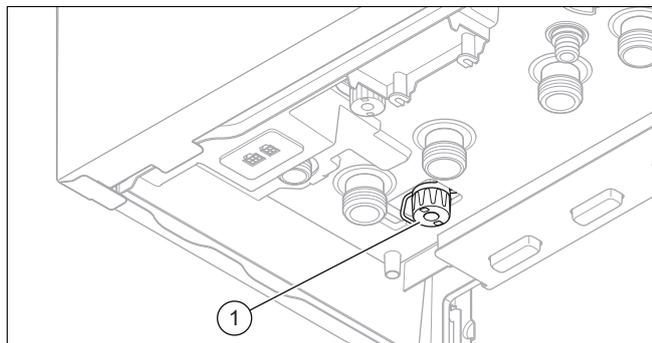
4. Raccordez le robinet de vidange du circuit chauffage (1) aux égouts.
