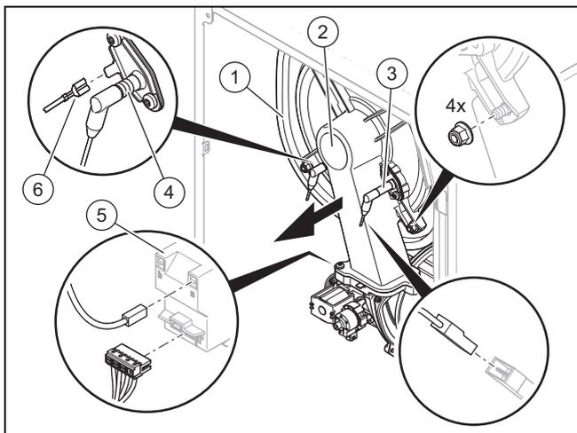
5. Débranchez le câble de mise à la terre (6) de l'électrode d'allumage (4), les deux connecteurs du transformateur d'allumage (5) et le connecteur du câble de l'électrode de régulation (3).
